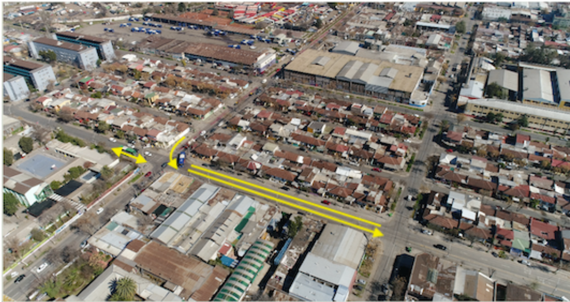
Figura 5. Grabación de video con el UAV DJI Phantom 4 desde una altura de 130m de un área con edificios de baja altura, permitiendo la extracción de parámetros de tráfico como velocidades, largo de colas, ocupación de pistas, porcentaje de virajes, entre otros.
