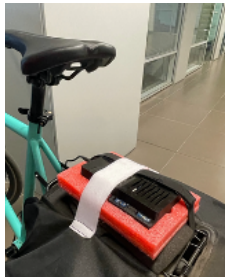
Figura A2: Montaje Contextino en la bicicleta
